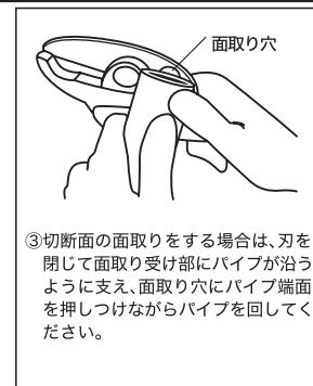
③切断面の面取りをする場合は、刃を閉じて面取り受け部にパイプが沿うように支え、面取り穴にパイプ端面を押しつけながらパイプを回してください。
