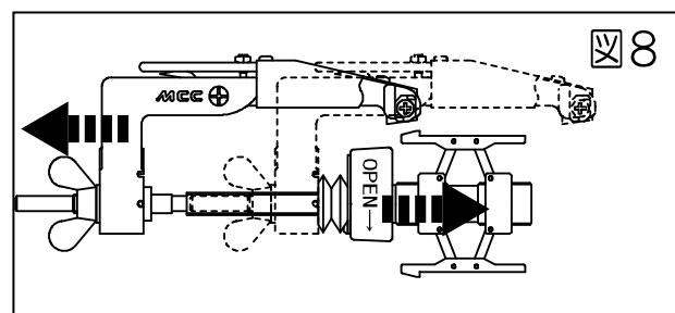
⑧「フレーム」を引いて、スクレーパ本体部を切削開始位置に戻して下さい。(図8)
