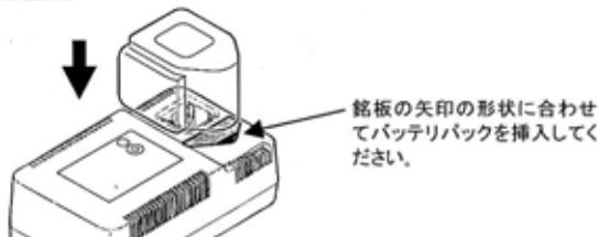
注：バッテリーパック挿入口にゴミや異物を絶対に入れないでください。故障の原因になります。バッテリーパックは挿入口の銘板に示す形状に合わせて挿入してください。別方向の挿入は行わないでください。故障の原因になります。6V バッテリー BP-6VR、BP-6VI は挿入しないでください。故障の原因となります。
