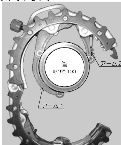
※管に扁平や曲げなど変形がある場合は、本体のみを切断箇所に取り付けて手で軽く回るか確認して下さい。手で軽く回せないほど変形の著しい管は切断できません。管の変形のない箇所を切断して下さい。
