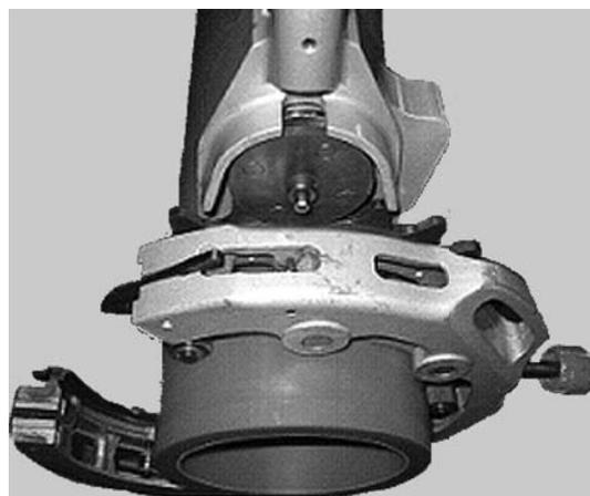
⑥駆動ハンドルを手で支えたまま「下側本体」を持ち上げ、フックを引っ掛けて本体を確実に閉じて下さい。
