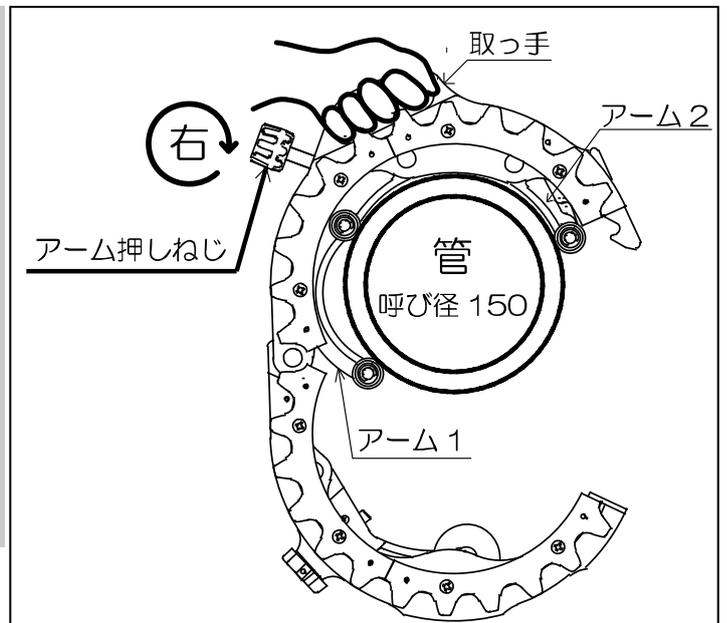
※呼び径100の管の場合は本体を少し持ち上げながら、「アーム1」「アーム2」の全てのローラが管に接するように取付けて下さい。
