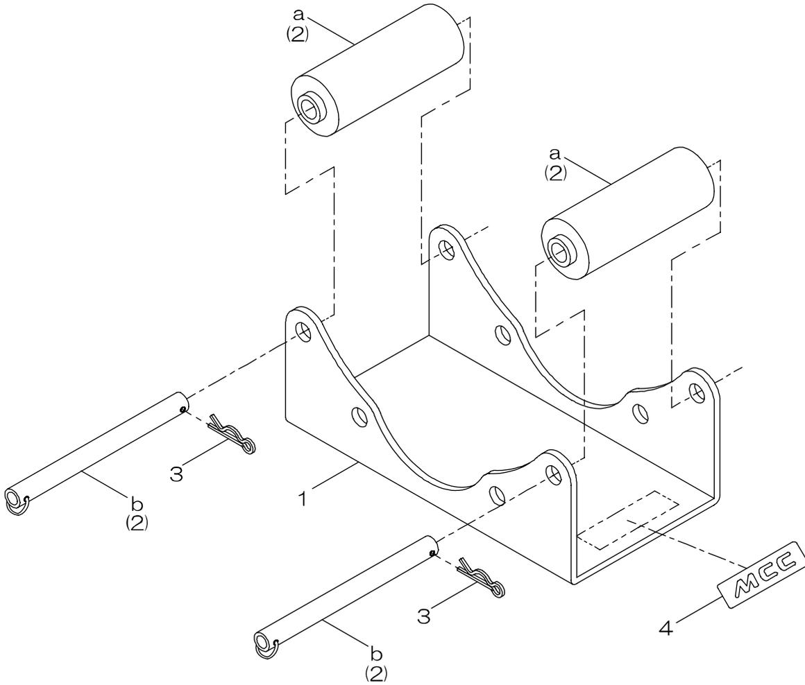
VPAS300A 塩ビ管切断アタッチメントパイプサポートA)
