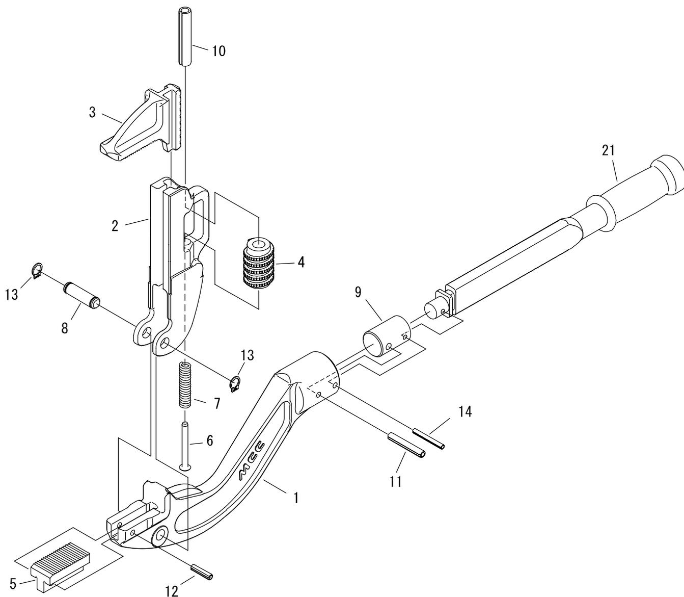
TQC1-50 (トルクレンチ(PE金属継手50用))
