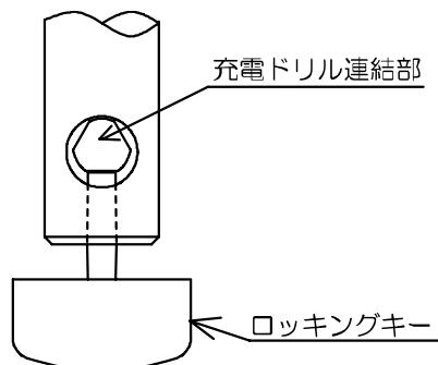
②「回転握り」とパイプ部を持ち、「回転握り」をしっかりと軸にして右回転し切削して下さい。
