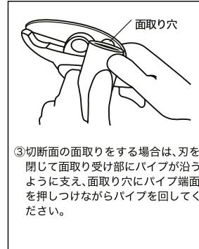
③切断面の面取りをする場合は、刃を閉じて面取り受け部にパイプが沿うように支え、面取り穴にパイプ端面を押しつけながらパイプを回してください。
