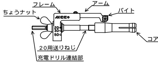
送りねじが変形(曲り)しているとスムーズに切削できず、切削不良の原因となります。
